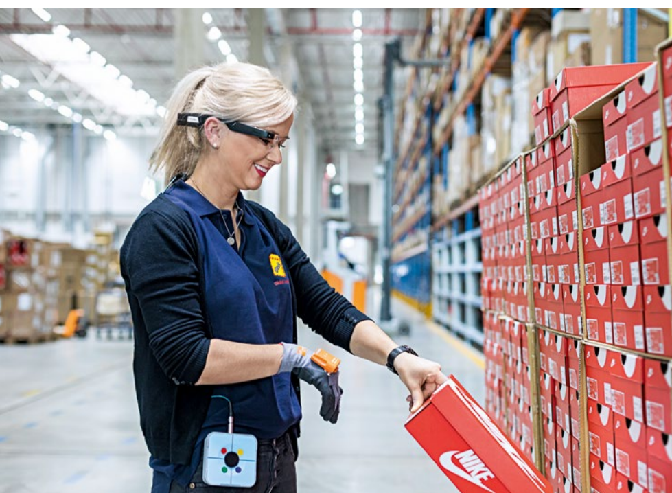
Clevere Kombination: Google Glass und Kommissionierhandschuh mit eingebautem Scanner.
